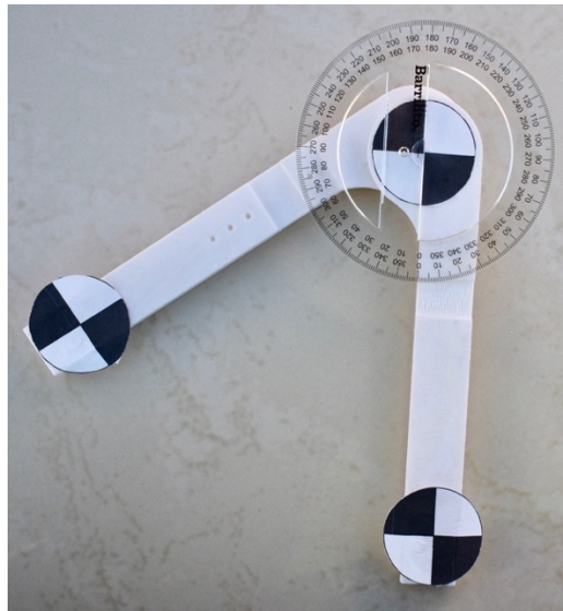
Figura 20. Medición del ángulo de rotación del EXOMAF.
